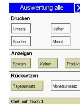
Auswertung - im Stand-Alone Betrieb kann die Auswertung direkt am Gerät erfolgen und auf einem angeschlossenen Bondruker ausgedruckt werden
